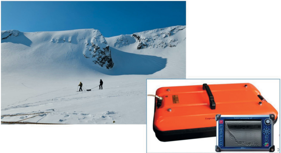
Рис. 4. Проведение радиолокационной съемки снежного покрова (фото А. Шеина, 18.04.2023)
