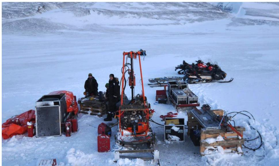
Рис. 5. Бурение установкой UNIS Permafrost Drill Rig на Шпицбергене. Справа виден керновый стол, оснащенный гидравлическим устройством для выдавливания керна из колонковой трубы
