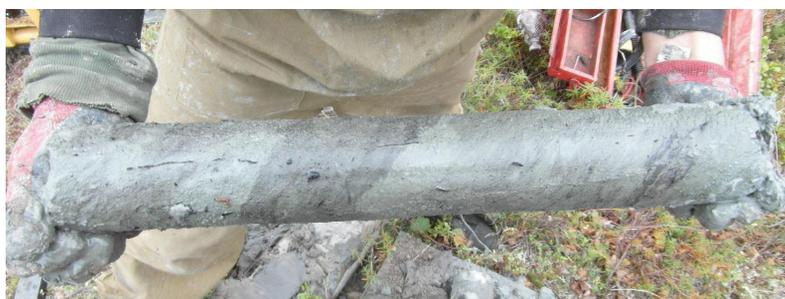
Рис. 3. Керн длиной 75 см, полученный при бурении мелких песков с массивной криотекстурой и включениями щебня, перекрывающими льдонасыщенное ядро булгуньяха Вась-Юган 1 в окрестностях г. Салехарда. Температура на забое скважины  $-0,5^{\circ}\text{C}$
