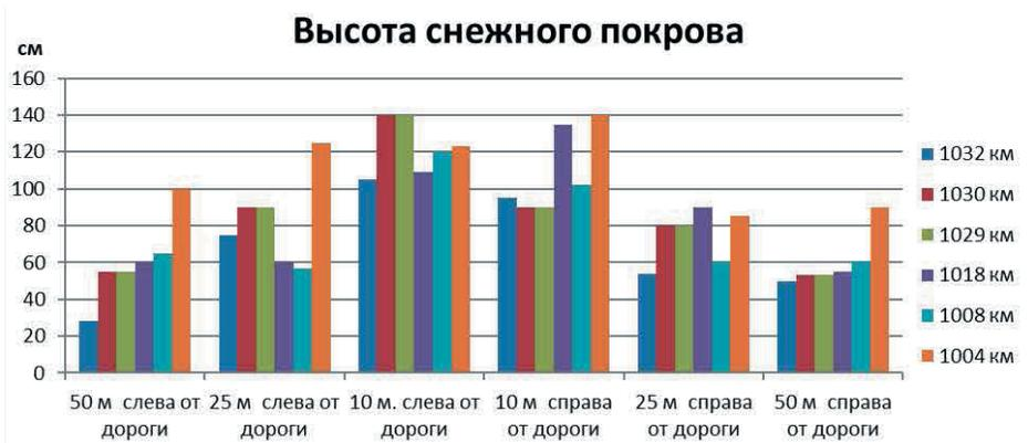
Рис. 3. Распределение высоты снежного покрова от центральной оси дорожного полотна по направлению в г. Надым
