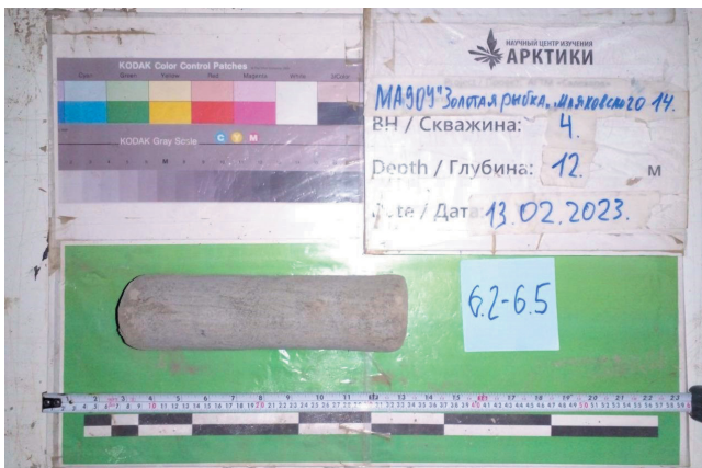
Рис. 4. Пример образца грунта ненарушенного сложения, песок средней крупности, мерзлый, криотекстура массивная. В талом виде средней плотности, ожелезненный, интервал 6,2-6,5 м, скв. 4
