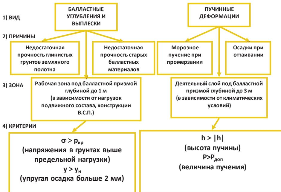
Рис. 3. Пучины на железнодорожном пути. Деформации основной площадки [5]
