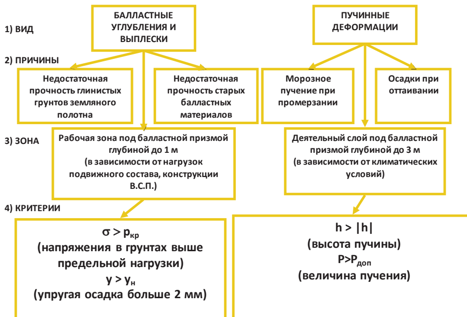
Рис. 3. Пучины на железнодорожном пути. Деформации основной площадки [5]
