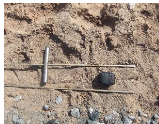
Щуп геолога для контроля глубины болота
