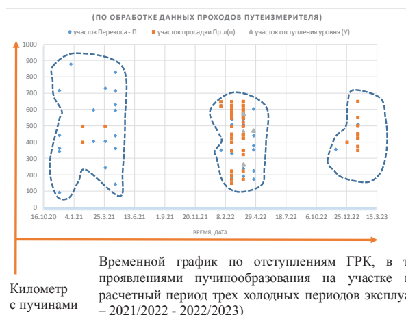
Рис. 4. Фиксация отступлений содержания рельсовой колеи при проходе вагона – путеизмерителя, справа на рисунке – проезд для выполнения работ текущего содержания пути
