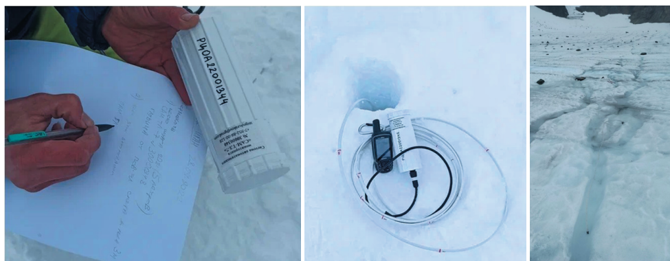
Рис. 1. Установка и сбор термометрического оборудования на леднике ИГАН
