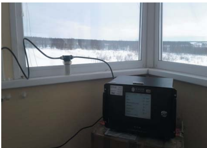
Рис. 2. Аэталометр АЕ33 для измерения концентрации черного углерода на Научно-исследовательском аэрозольном посту вблизи г. Салехард
