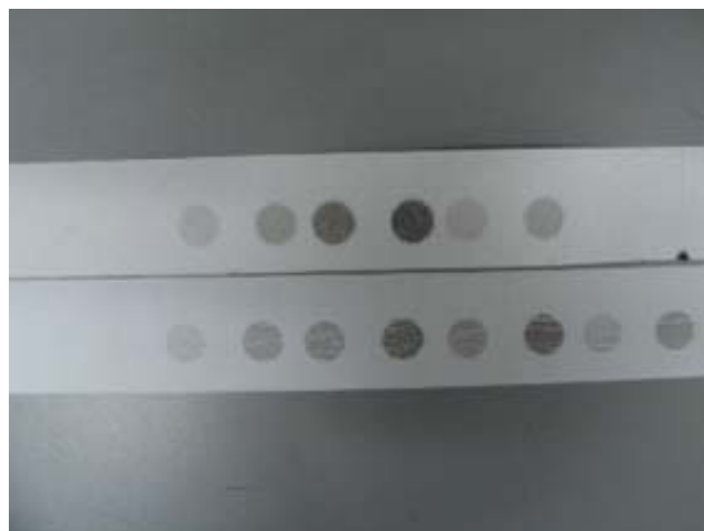
Рис. 3. Пятна осажденных из атмосферы частиц на ленте аэталометра АЕ 33
