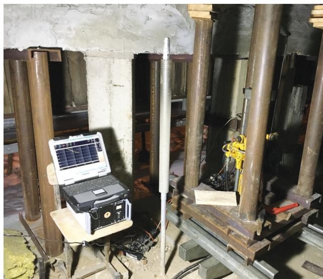
Рис. 7. Мобильная установка статического зондирования во время испытания
