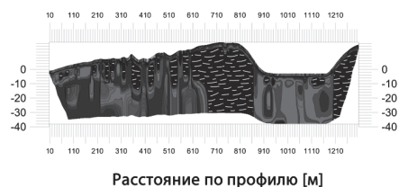
Рис. 6. Геоэлектрический разрез по профилю о. Курунгнах, вдоль южного берега оз. Удачное (Lucky Lake). Ось X сжата относительно оси Y в 6 раз.
