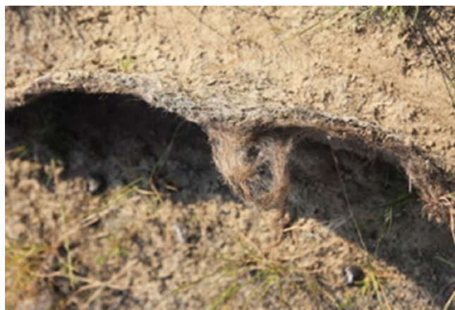
Рис. 4. Мониторинговые исследования 2014 года участка с минимальным слоем нанесенного грунта, рекультивированного биоматами БТ-СО/130 (2,0)
