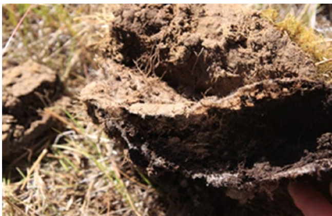
Рис. 6. Участок, рекультивированный торфоматами на участке со слоем нанесенной почвы до 10 см, 2016 г.
