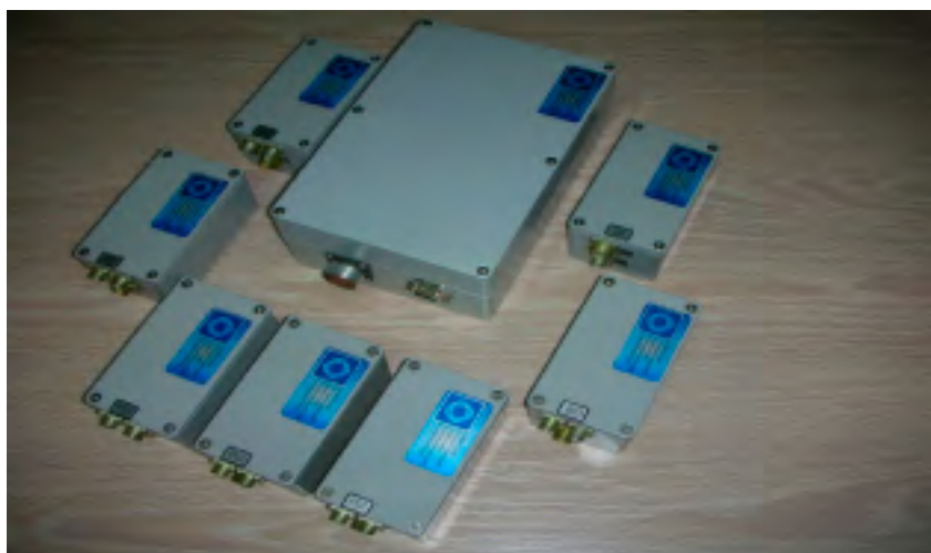
Рис. 3 – Комплект гидроакустических модулей для оборудования глубоководного сейсмического полигона[1]
