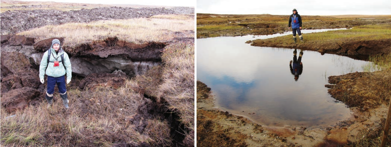
Рис. 4а, 4б. Развитие антропогенных термокарстовых воронок вдоль трассы МГ. Ямал — сравнительный анализ одного и того же места 2009 и 2010 гг.
