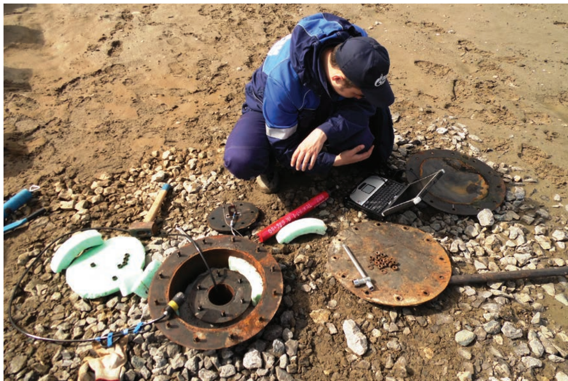
Рис. 10. Снятие показаний термометрических скважин во время полевых работ на Ямале, июль 2015 г.
